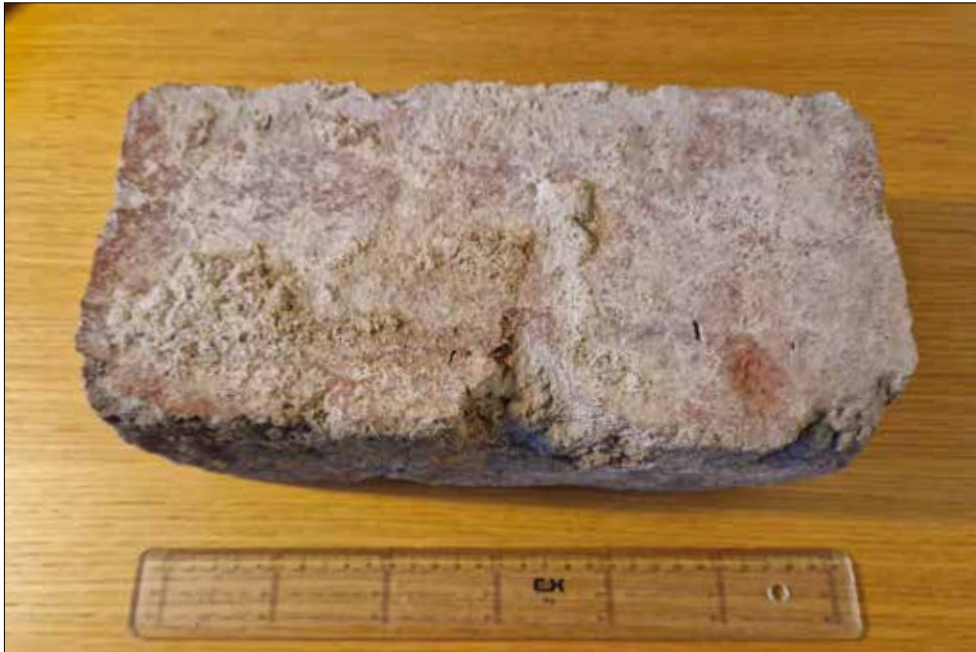
Figur 45. En av tegelstenarna som sannolikt kommer från Rudbeckianska gymnasiets föregångare tillvaratogs. Fyndet (F11) påträffades i lager A504 i sektion 6 och 7. Tegelstenen var 0,30×0,14×0,095 meter stor. Kalkbruk finns på fem sidor av tegelstenen.
